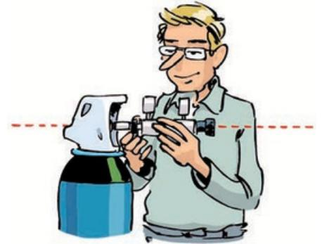
Placez-vous sur le côté de la bouteille de manière à ne pas être face au détendeur. Présentez le détendeur dans l'axe de la bouteille.
