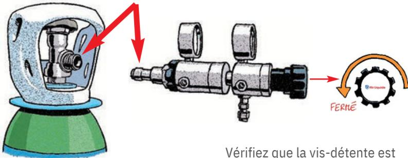
Vérifiez que la vis-détente est desserrée (= détendeur fermé).
