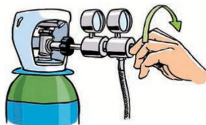
Réglez la pression d'utilisation en tournant la vis du détendeur.
