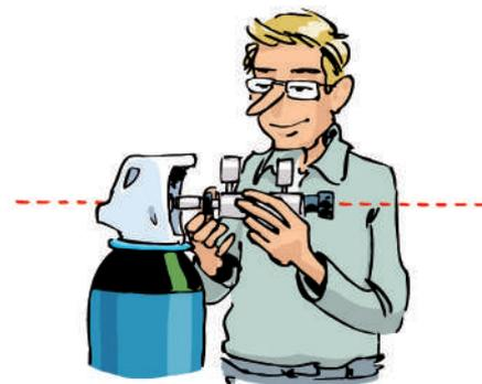
Placez-vous sur le côté de la bouteille de manière à ne pas être face au détendeur. Présentez le détendeur dans l'axe de la bouteille.
