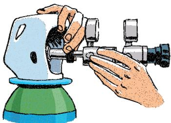
Si le détendeur possède un joint torique, vissez-le A LA MAIN en tenant correctement la douille. Ni clé, ni pince, pour ne pas endommager le matériel.
