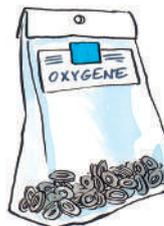
N'utiliser que des joints spéciaux oxygène.
