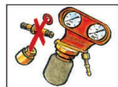
Ne bricotez jamais les raccords et les détendeurs.
