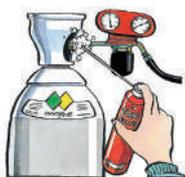
• Testez l'étanchéité avec le détecteur "1000 Bulles".
