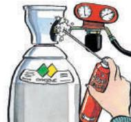
Tester l'étanchéité avec le "1000 bulles".
