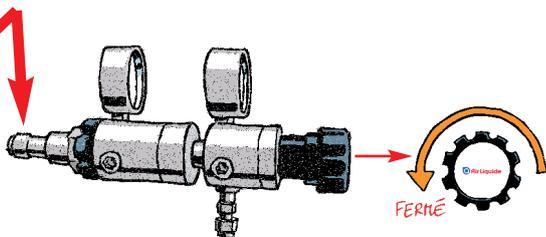
Vérifiez que la vis-détente est desserrée (= détendeur fermé).
