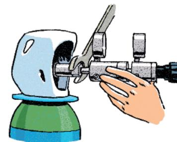
Si le détendeur possède un joint plat, vissez-le à l'aide d'un outil.
