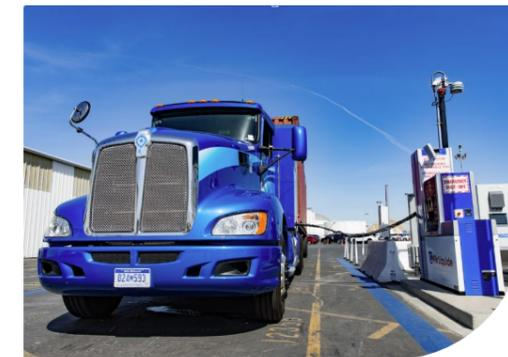
Conçue par Air Liquide, cette station hydrogène bas carbone de grande capacité [700 bar, 1 tonne/jour] permettra jusqu'à 20 rechargements journaliers de camions hydrogène effectuant de longues distances, leur autonomie pourra aller jusqu'à 800 kms.
