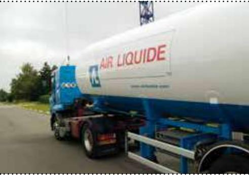
Certains gaz peuvent être livrés et stockés en phase liquide à très basse température, dans des réservoirs d'une capacité allant de 6 000 à 50 000 litres.
