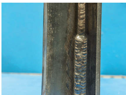
Soudage multi-passes en verticale montante
